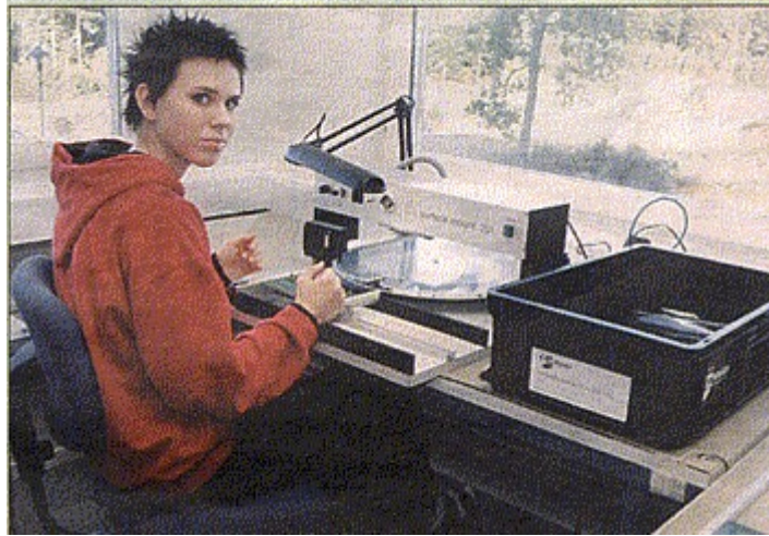
Ibland är det inte meningsfullt att automatmontera korten. Då kan man använda den manuella ytmonteringsutrustningen som Lisa Joslin arbetar med.
