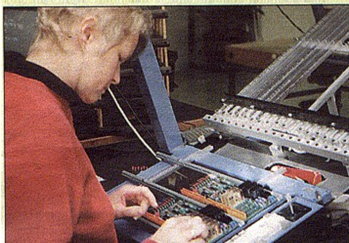
Hålmonteringen är manuell och sker bl a i "datorstyrda" monteringsbord av typ Logpoint som Catarina Juhlin arbetar vid.
