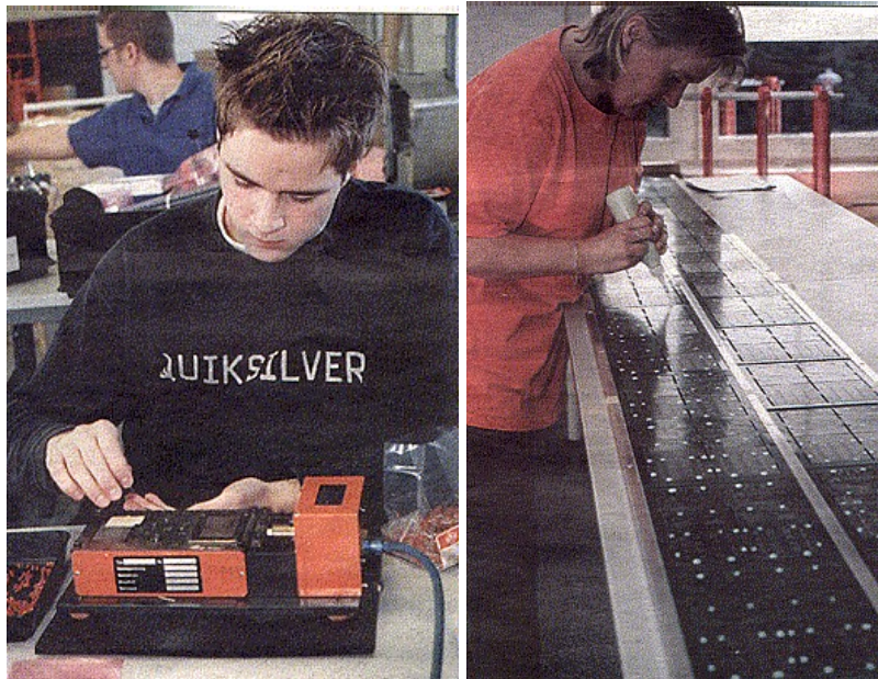
En del komponenter kräver förarbete. Det kan vara kapning och böckning av anslutningar. Här arbetar Tomas Palmqvist med det.
